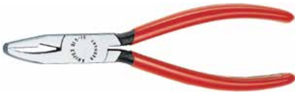
200.202 KNIPEX Glaskröselzange Breite 9 mm Zum Nachformen und Säubern der Kanten. Eine Backe gebogen, auf der Innenseite gerillt. Spezialwerkzeugstahl ölgehärtet, Griffe kunststoffüberzogen
