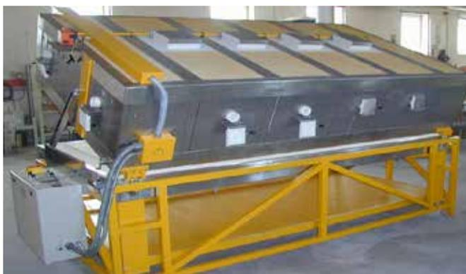
Automatische Deckelöffnung über Steuerung regelbar.
