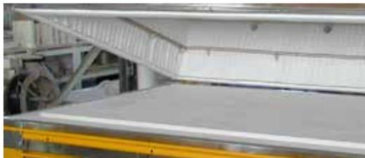
Peripheres Zusatzelement im Ofendeckel, auch separat steuerbar (Master/Slave Steuerung).
